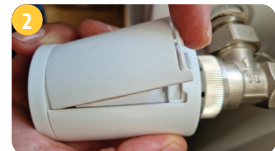
Odstráňte kryt batérie umiestnený na bočnej strane zariadenia.
