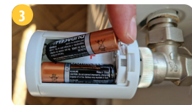
Vložte batérie podľa označenia a zatvorte kryt batérií.
