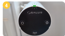
LED dióda začne blikať na zeleno / červeno a informuje o verzii softvéru.
