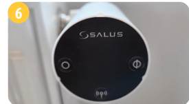
Keď LED dióda zhasne a hlavica TRV nevydáva žiadne zvuky, proces adaptácie je ukončený. Zariadenie je pripravené na spárovanie s termostatom.
